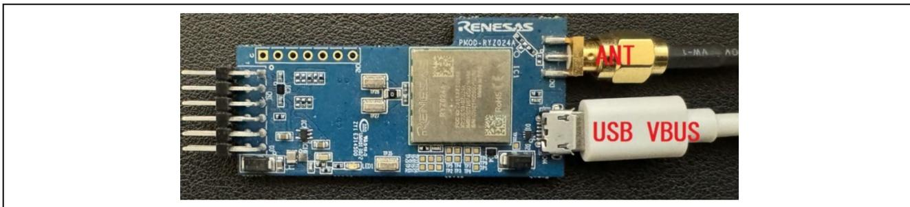
図 5-3 アンテナと電源供給用の USB ケーブルを RYZ024A に接続
