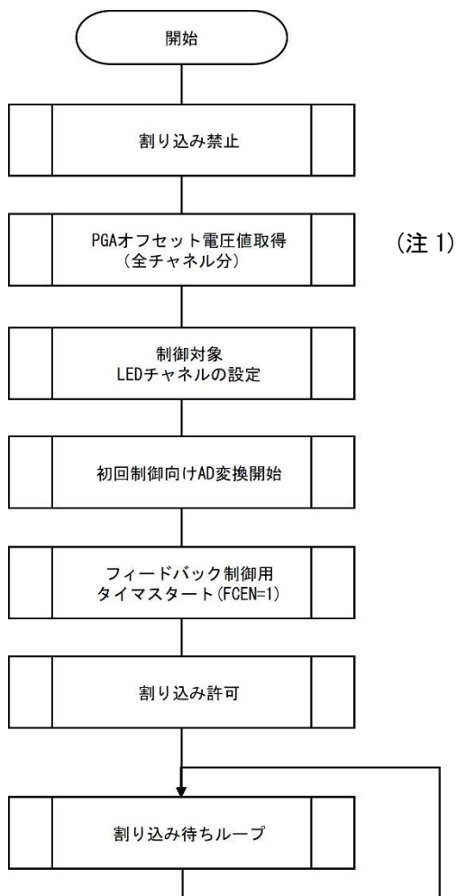
図 6-4 LED 制御開始処理(高速動作)
