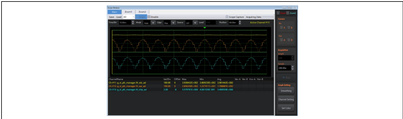
図 12-1 PFC 制御の 390V 昇圧状態波形
