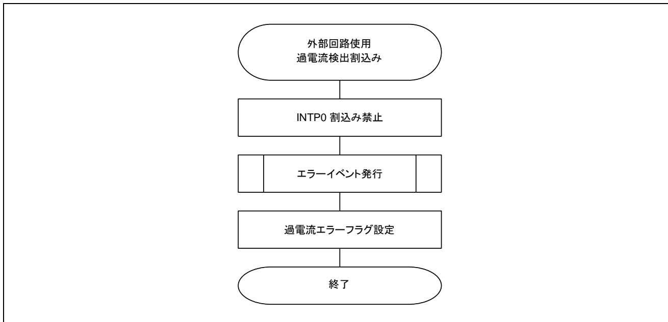
図 3-10 過電流検出割り込み処理フローチャート（外部回路使用時）
