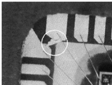
図 3.8 パッケージ内の導電性異物混入によるショート
