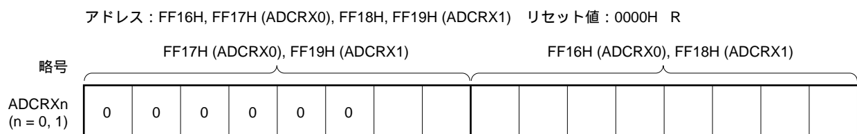
図11 - 8 TMX n 同期用10ビットA/D変換結果レジスタ (ADCRX n ) のフォーマット
