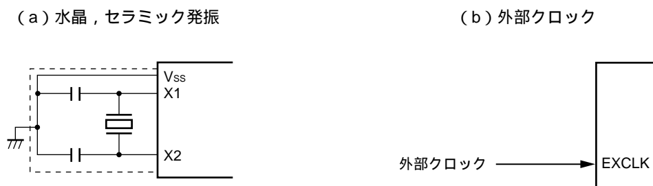
図5 - 9 X1発振回路の外付け回路例
