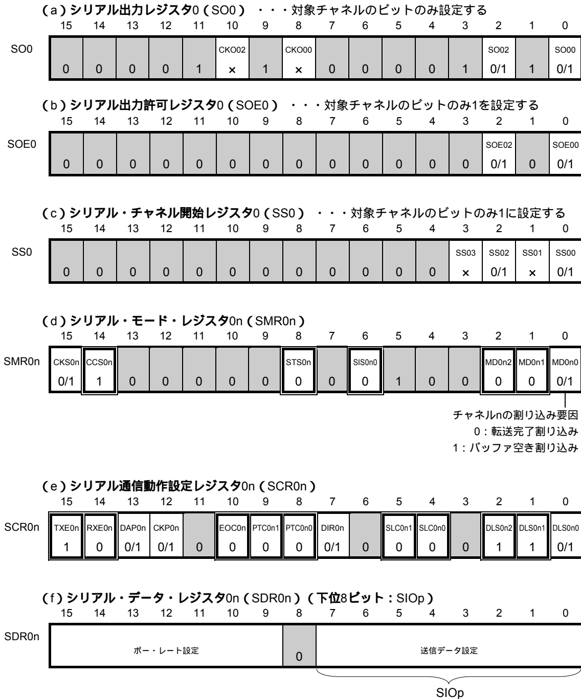
図11 - 48 3線シリアルI/O (CSI00, CSI10) のスレーブ送信時のレジスタ設定内容例
