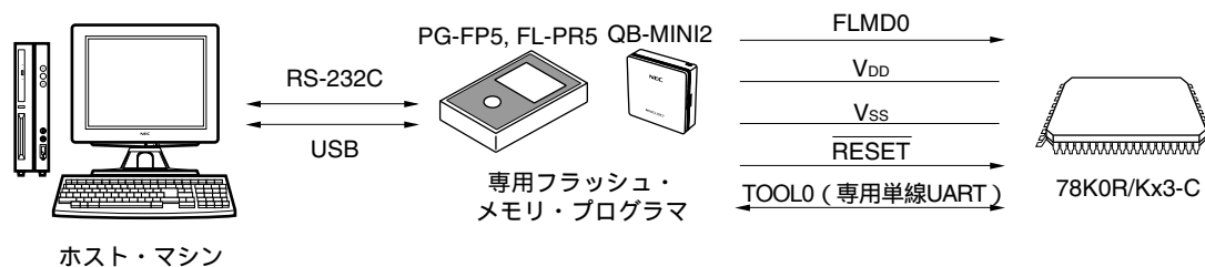
図25-3 フラッシュ・メモリにプログラムを書き込むための環境
