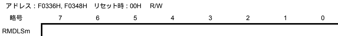
図14 - 18 リモコン受信DLSコンペア・レジスタ m (RMDLS m ) のフォーマット
