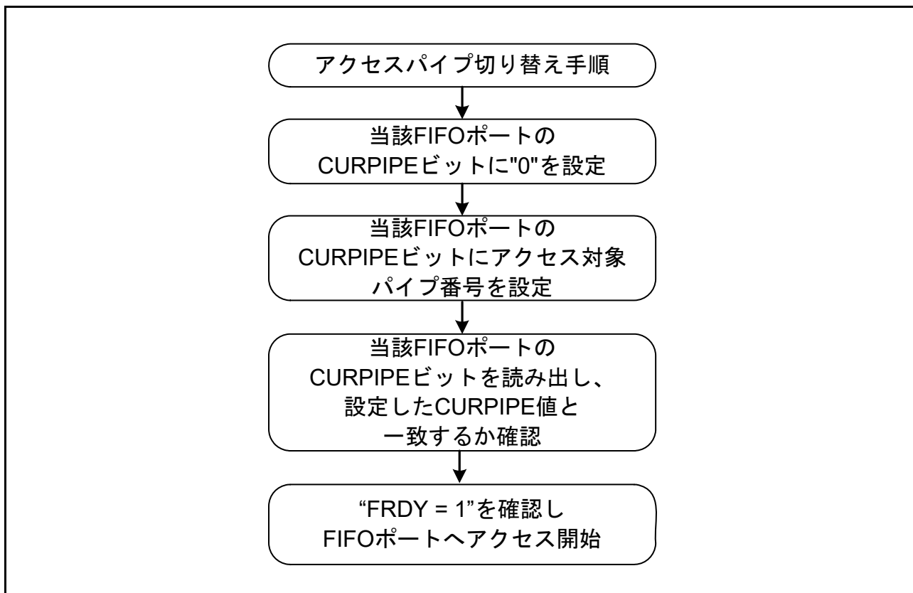
図 24.11 FIFO ポートアクセス時の PIPE 切り替え手順
