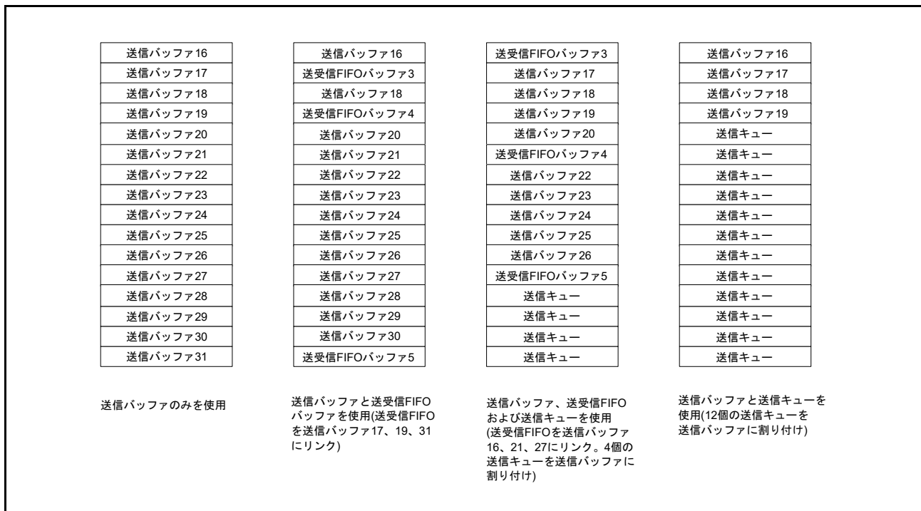
図 27.9 送信キューの割り付けと送受信 FIFO バッファのリンク
