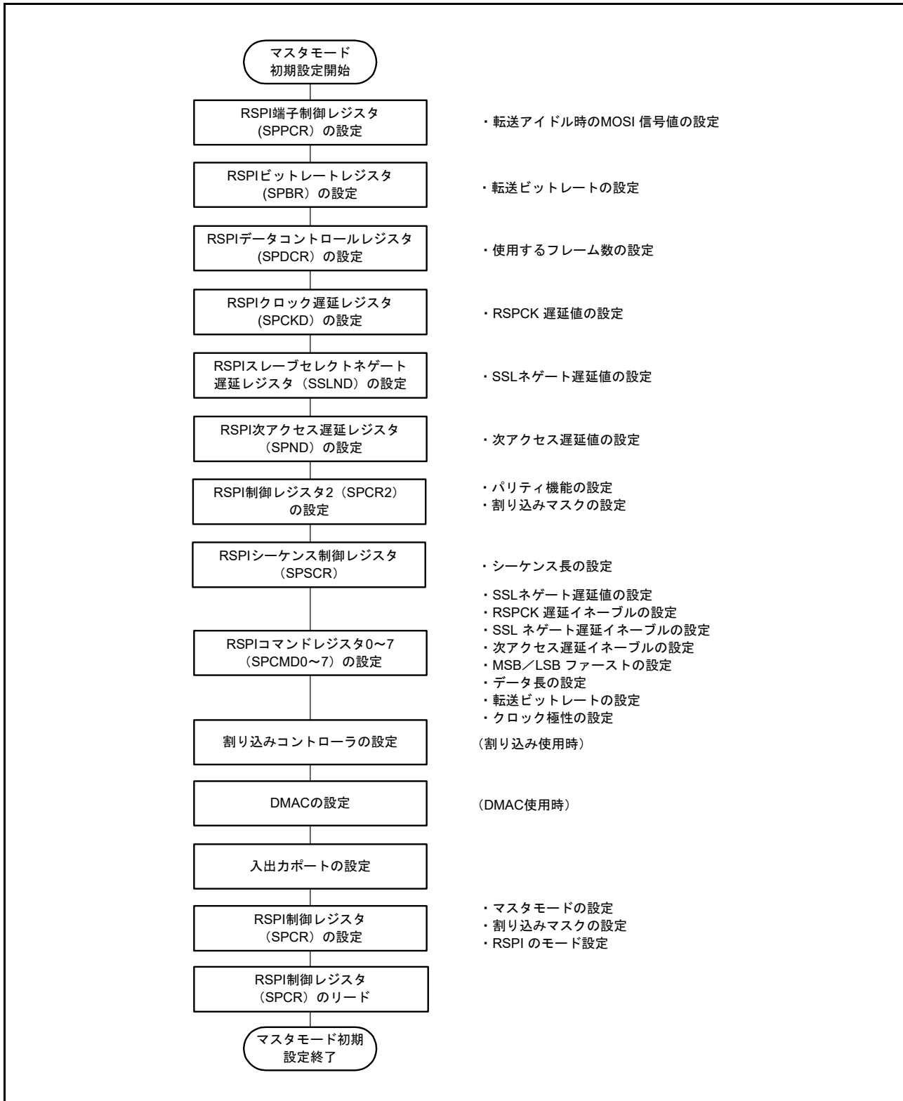
図 28.46 マスターモード時の初期化フロー例 (クロック同期式動作)
