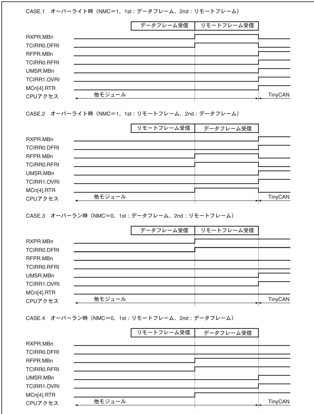
図 15.16 オーバーラン・オーバーライト発生時のRXPR/RFPRのセット・クリアタイミング図
