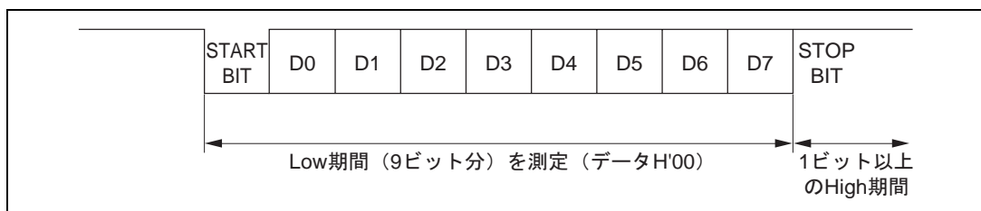
図 19.68 SCI ビットレートの自動合わせ込み動作
