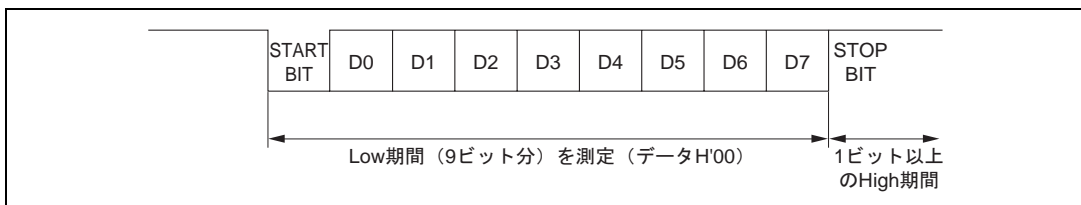
図 19.38 SCI ビットレートの自動合わせ込み動作
