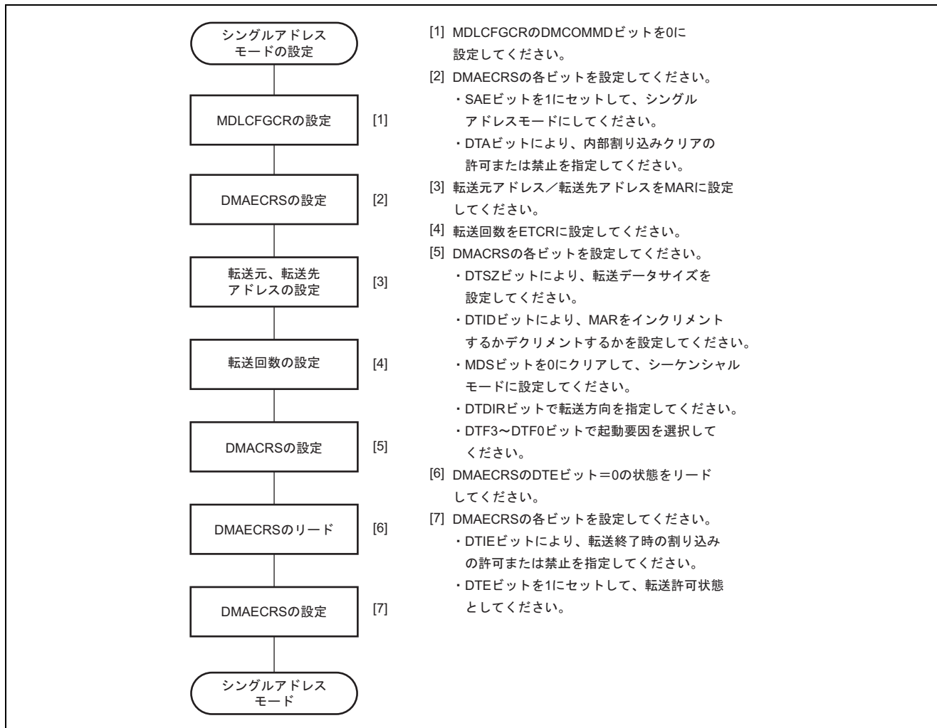
図 8.13 シングルアドレスモード（シーケンシャルモード指定）の設定手順例 （共通レジスタ無効モード）
