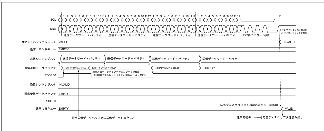
図 30.29 HDR データ書き込み転送 (HDR-TSP、TSL) タイミング (2/2)
