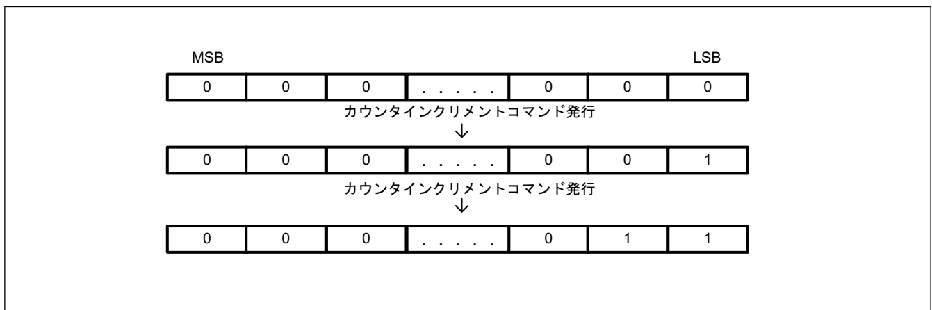
図 46.43 アンチロールバックカウンタのインクリメントのイメージ
