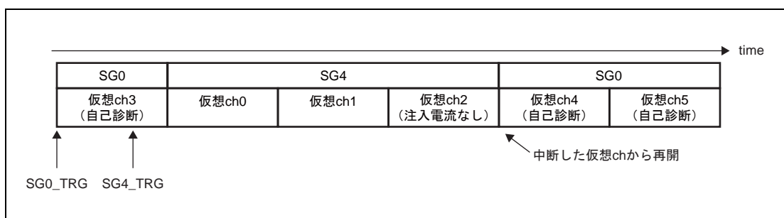
図 26.17 A/D 変換回路自己診断よりも高優先となる SG がある場合の設定例
