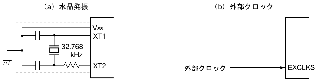
図5-22 XT1 発振回路の外付け回路例
