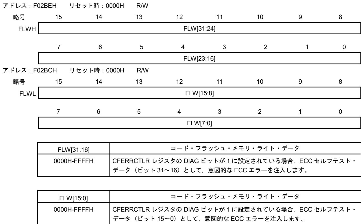
図 28-30 フラッシュ・ライト・バッファ・レジスタ (FLWH/FLWL) のフォーマット
