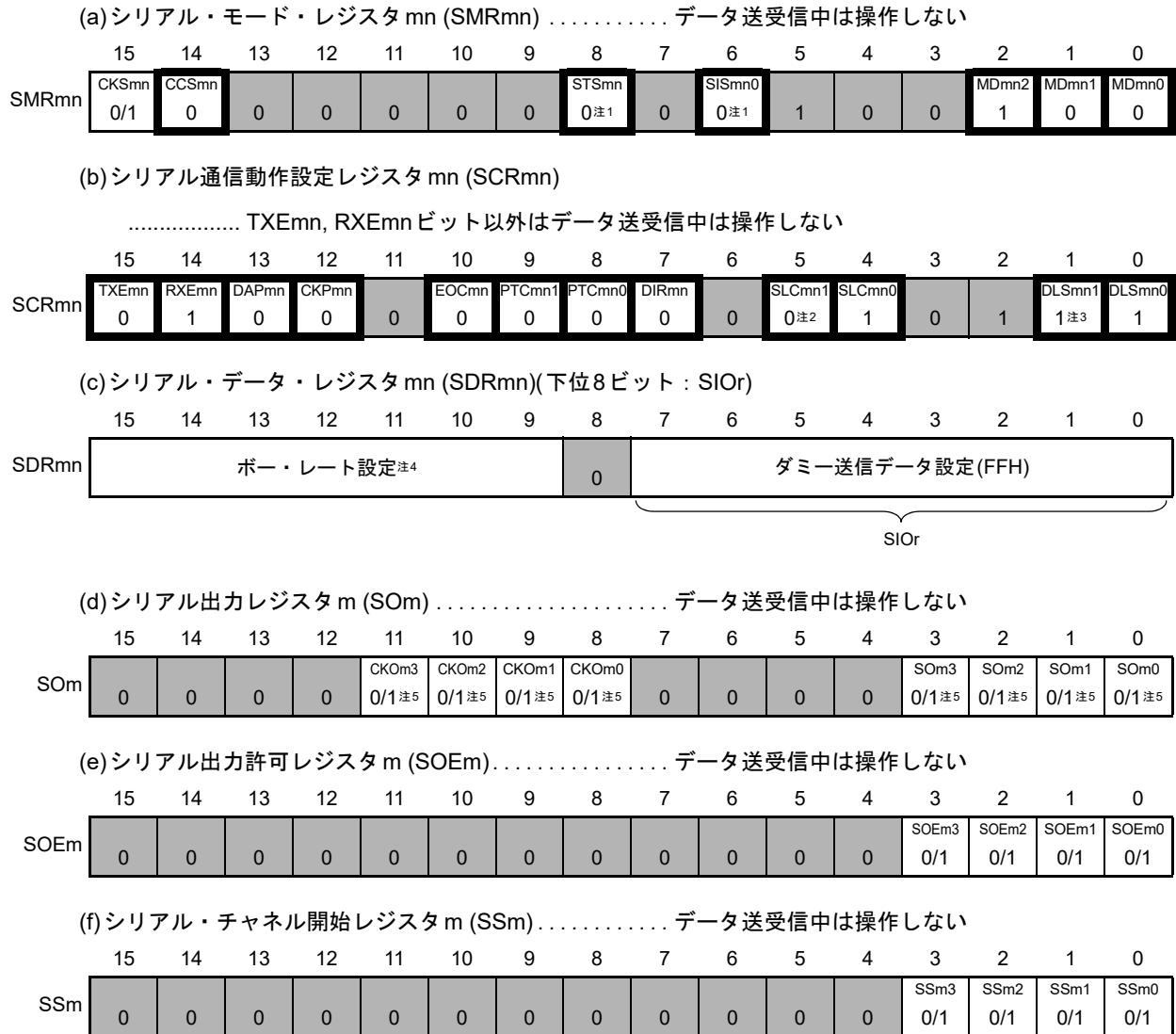
図 17 - 143 簡易 I 2 C (IIC00, IIC01, IIC10, IIC11, IIC20, IIC21, IIC30, IIC31) のデータ受信時のレジスタ設定内容例
