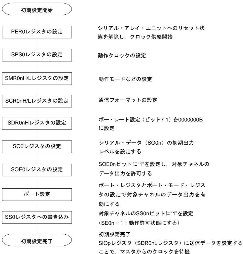
図11-61 スレーブ送受信の初期設定手順
