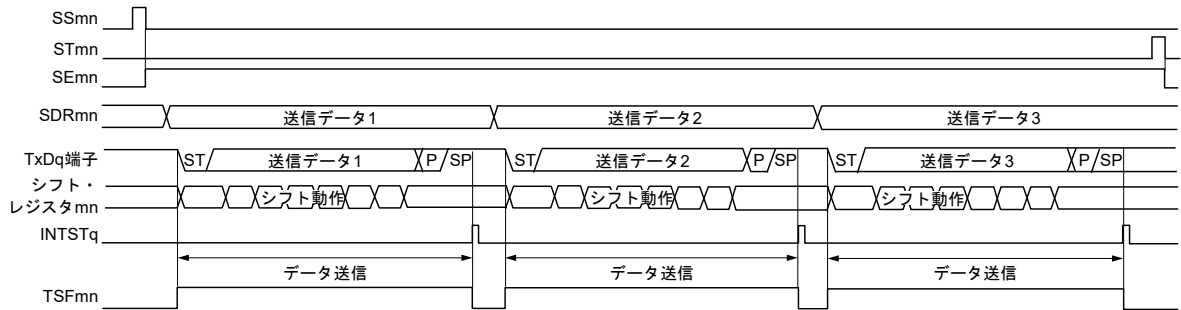
図19 - 110 UART 送信 (シングル送信モード時) のタイミング・チャート
