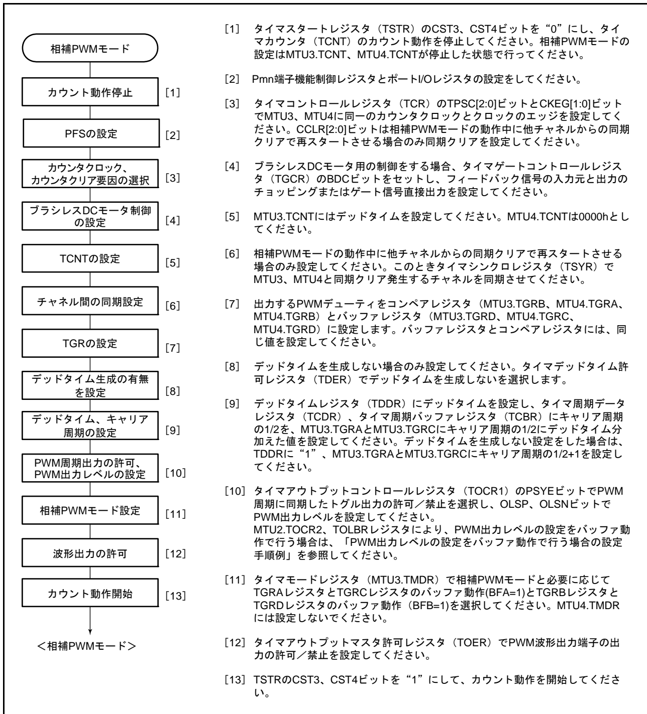
図 21.38 相補 PWM モードの設定手順例
