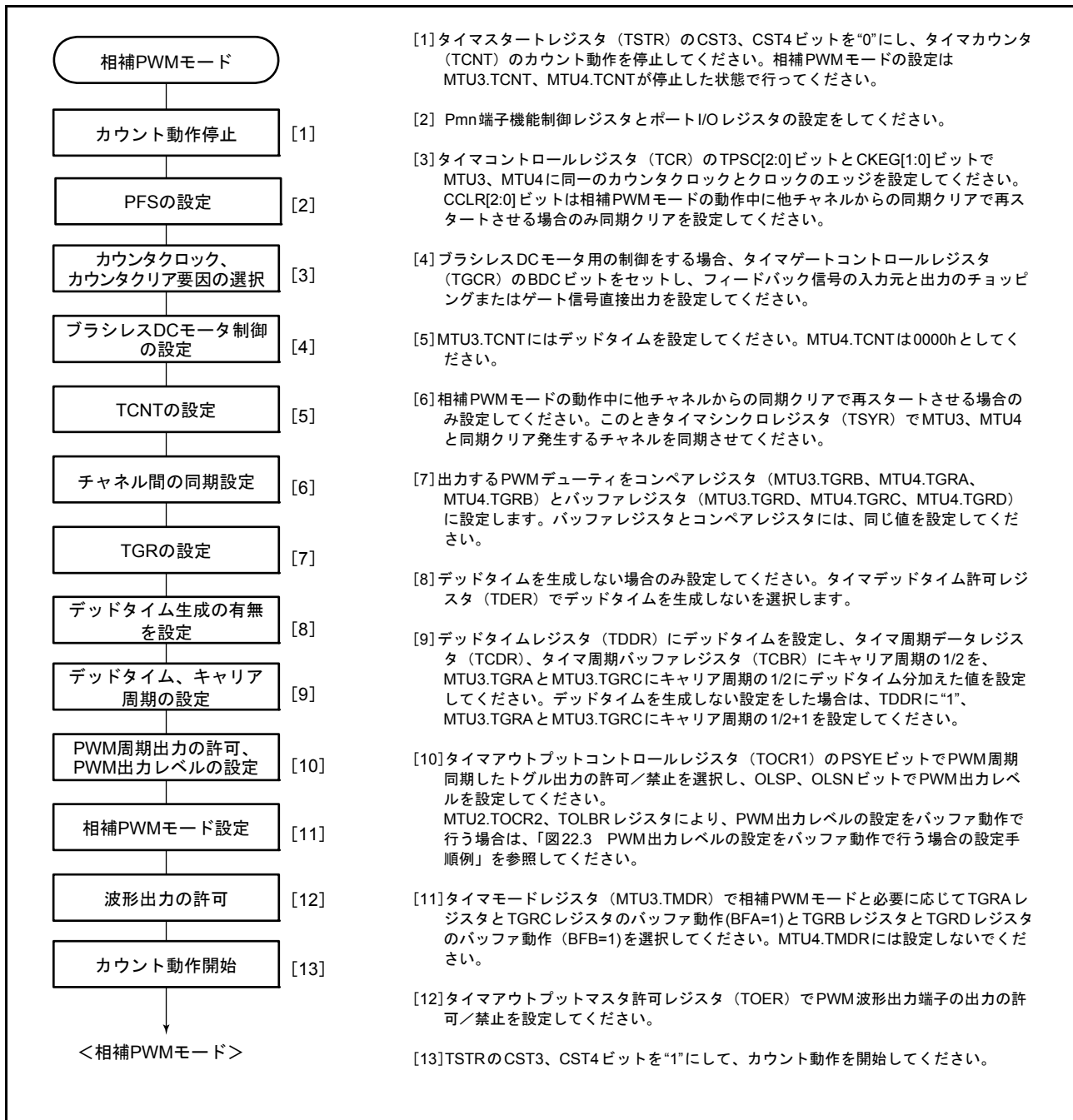
図 22.38 相補 PWM モードの設定手順例
