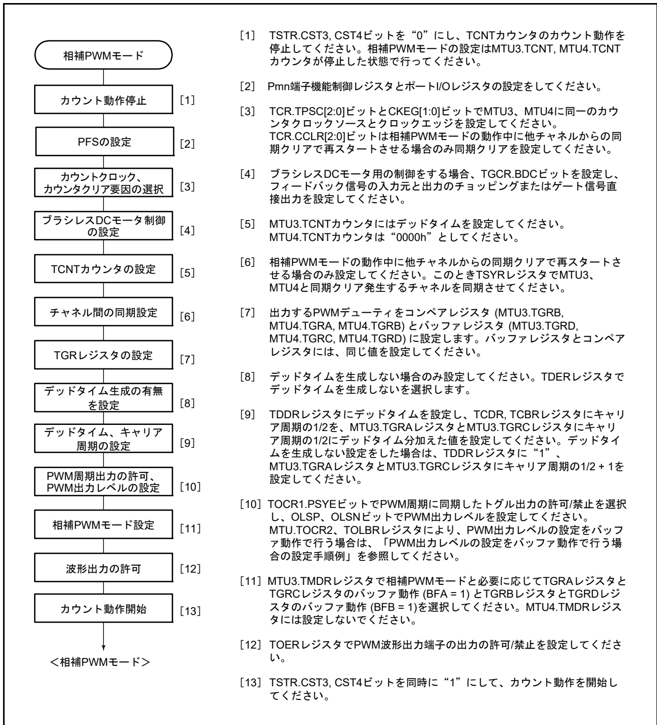
図 23.38 相補 PWM モードの設定手順例
