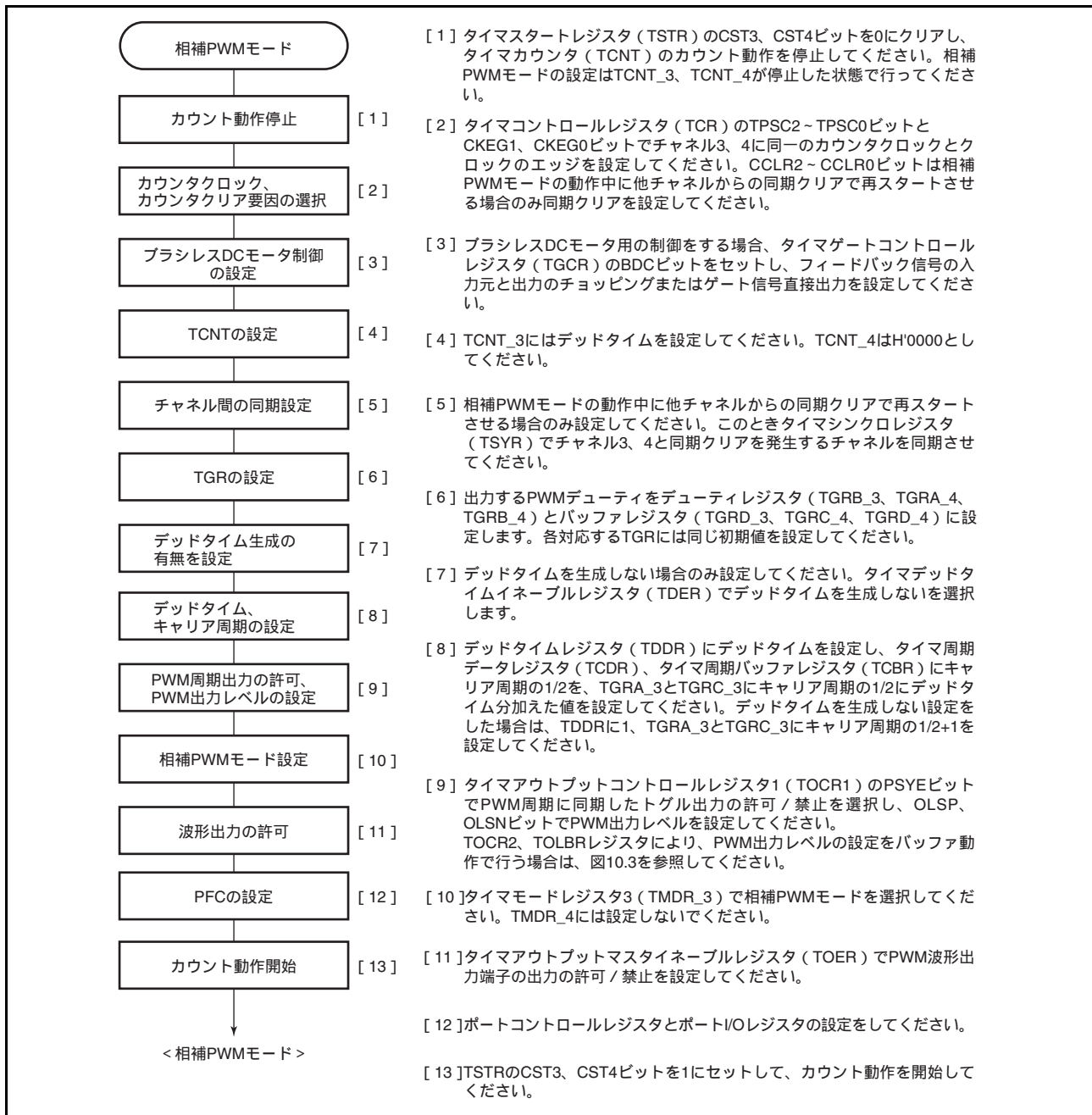
図 10.38 相補 PWM モードの設定手順例
