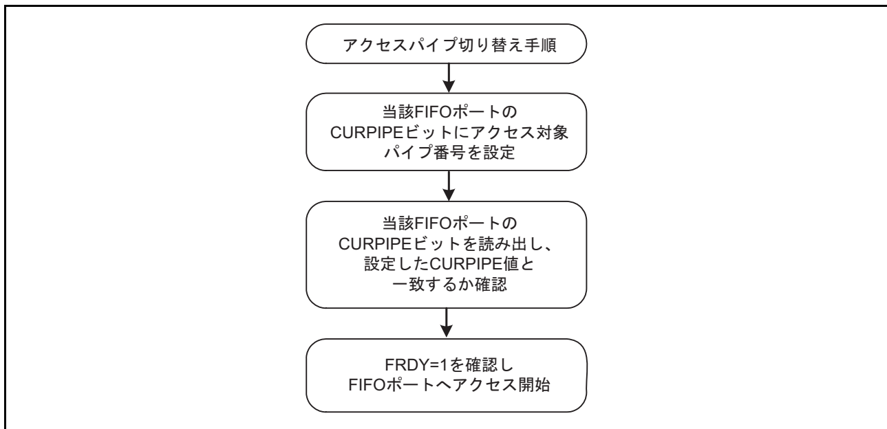
図 28.10 FIFO ポートアクセス時のパイプ切り替え手順
