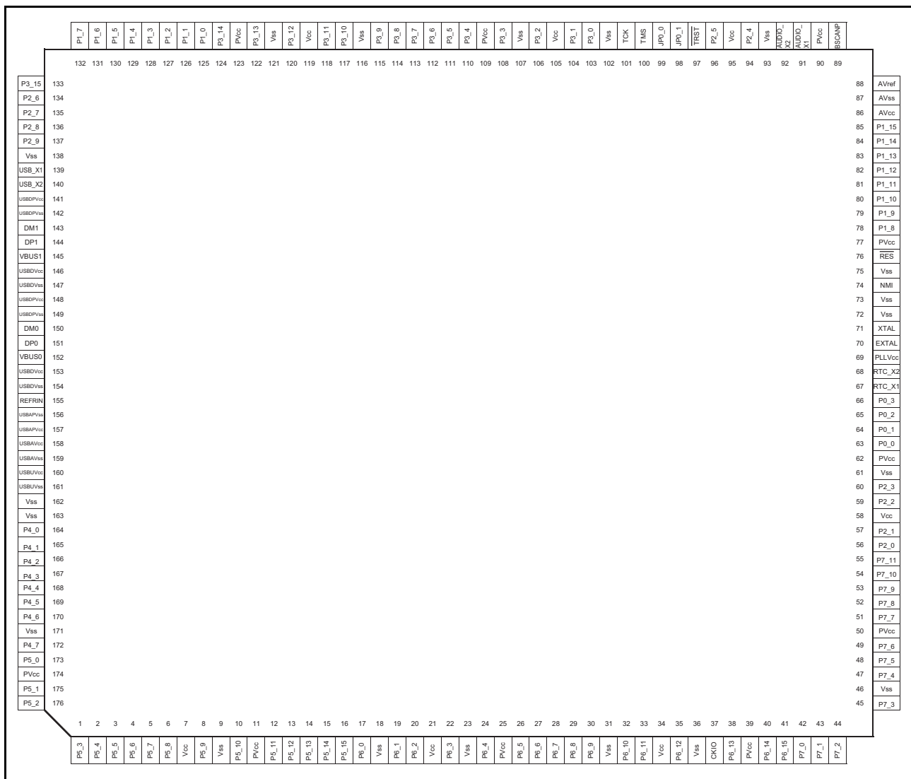
図 1.2 176ピンQFP版ピン配置図(上面図)
