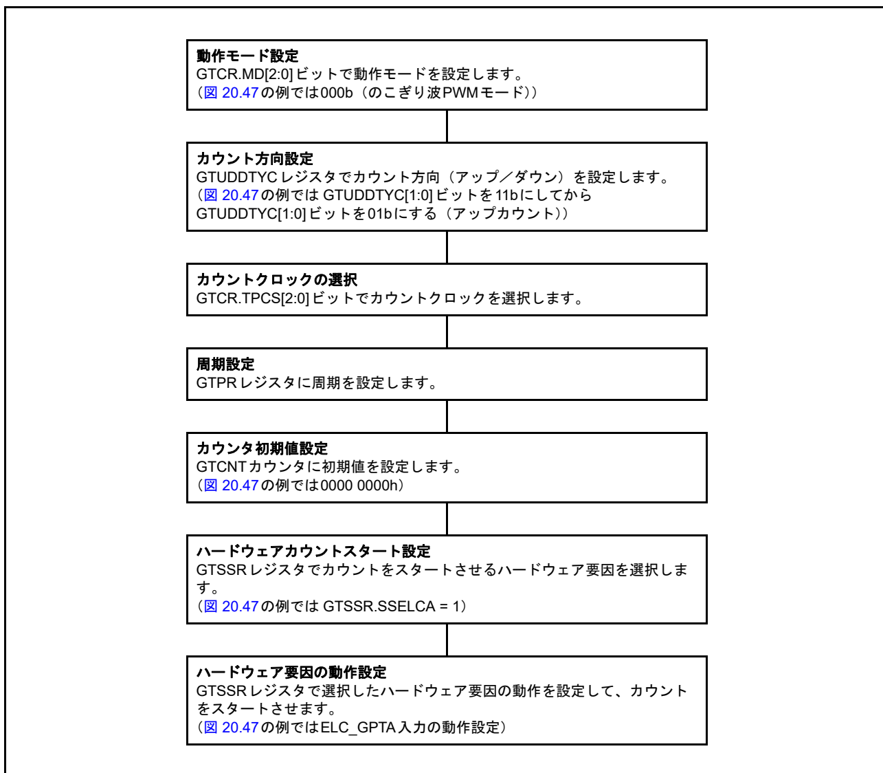
図 20.48 ハードウェア要因によるカウントスタート動作設定例
