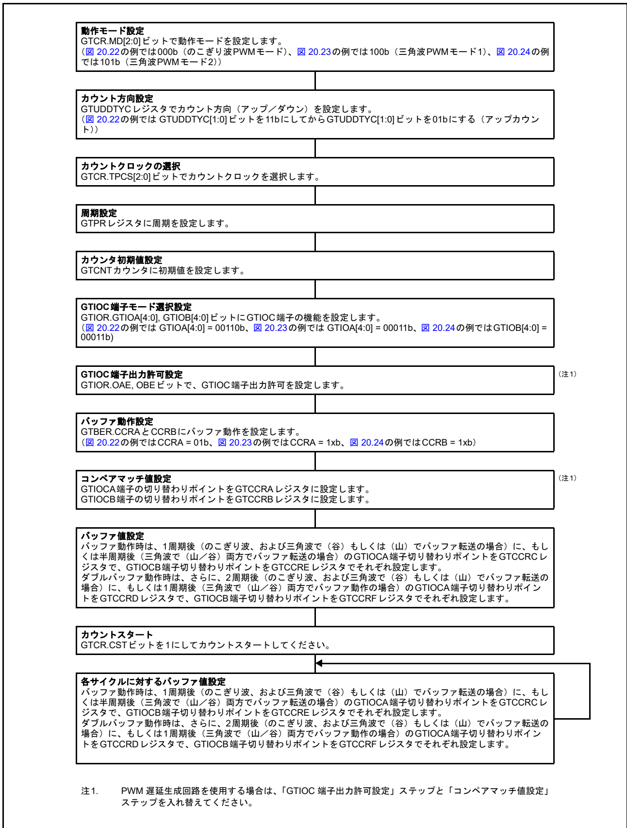
図 20.25 GTCRA、GTCCRB レジスタのバッファ動作設定例 (アウトプットコンペア時)
