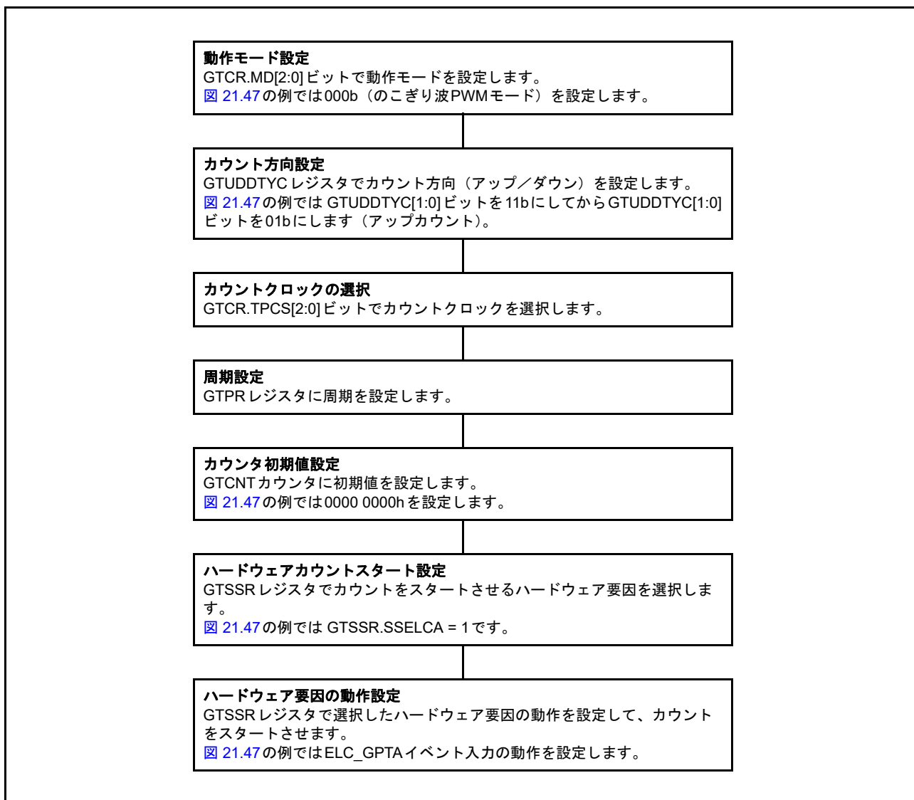
図 21.48 ハードウェア要因によるカウントスタート動作設定例
