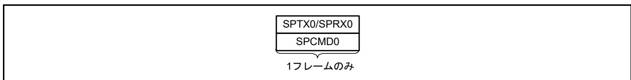
図 31.34 シーケンス動作時の SPI コマンドレジスタと送受信バッファの関係
