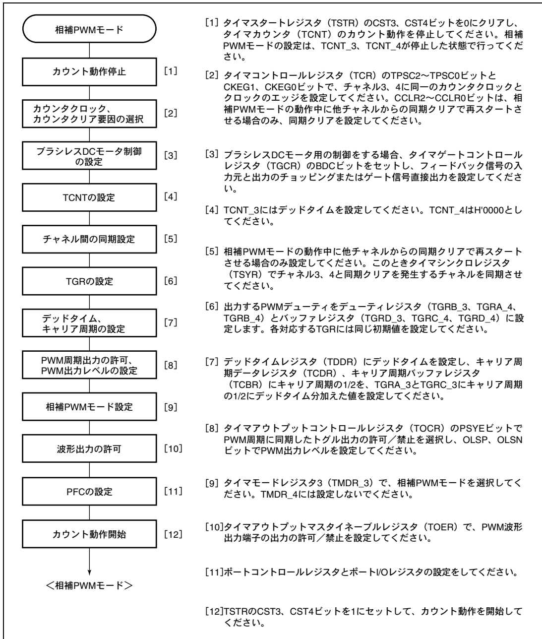
図 10.33 相補 PWM モードの設定手順例
