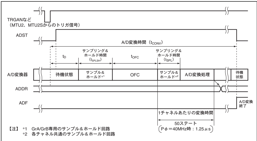
図 17.5 A/D 変換タイミング (1 サイクルスキャンモード)
