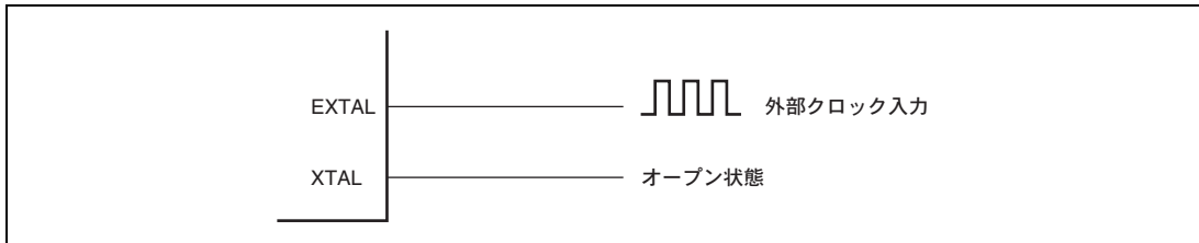
図 4.4 外部クロックの接続例
