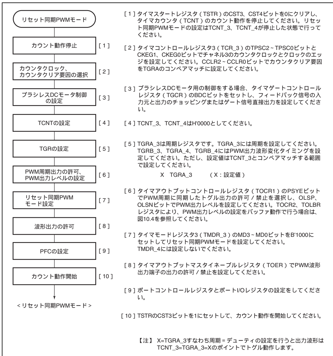
図 10.36 リセット同期 PWM モードの設定手順例
