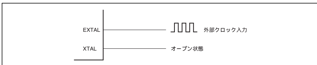
図 4.4 外部クロックの接続例
