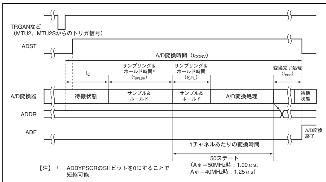
図 19.9 A/D 変換タイミング
