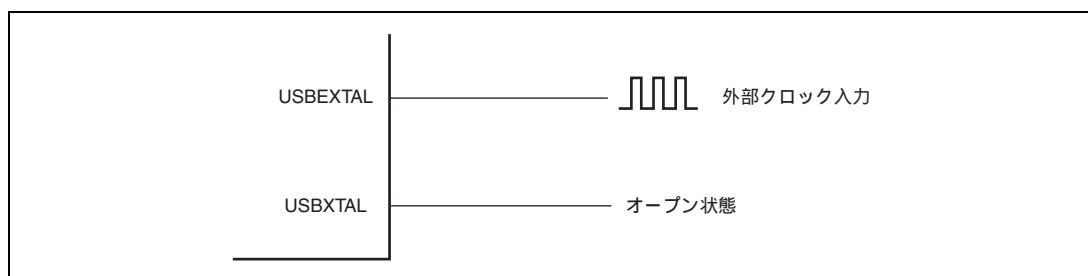
図 4.6 外部 48MHz クロックの接続例
