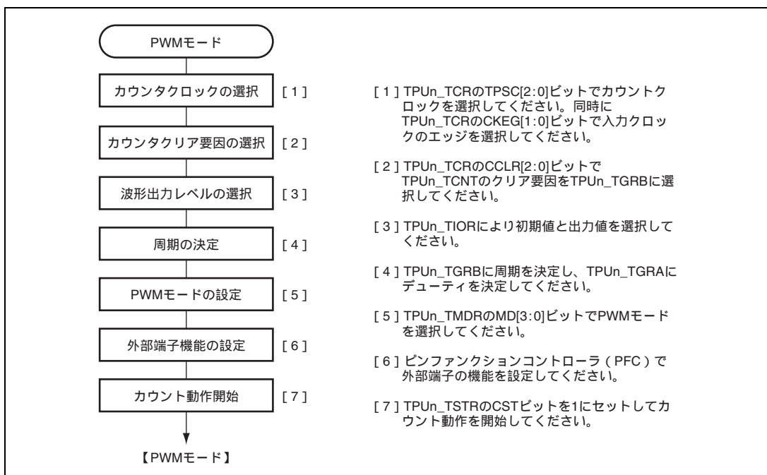
図16.11 PWM モードの設定手順例
