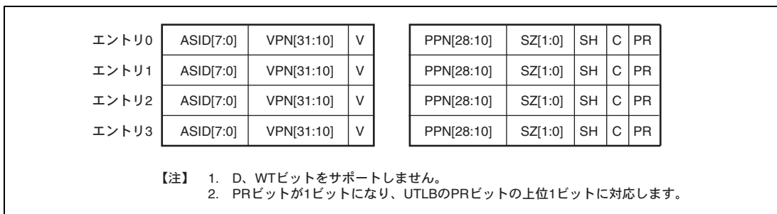
図 2.34 ITLB の構成 (TLB 互換モード)
