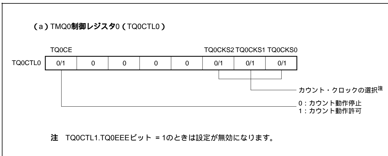
図7 - 23 外部トリガ・パルス出力モード動作時のレジスタ設定内容 (1/3)
