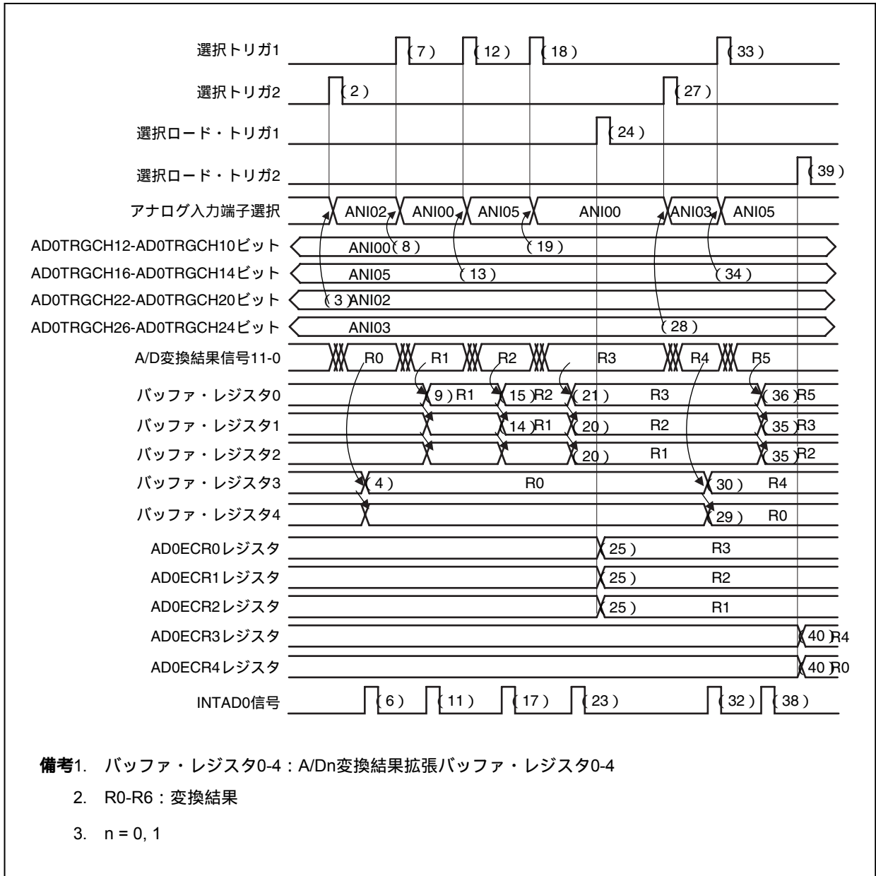
図12 - 22 拡張バッファ・モードの動作例：A/Dコンバータ0の場合（1/2）
