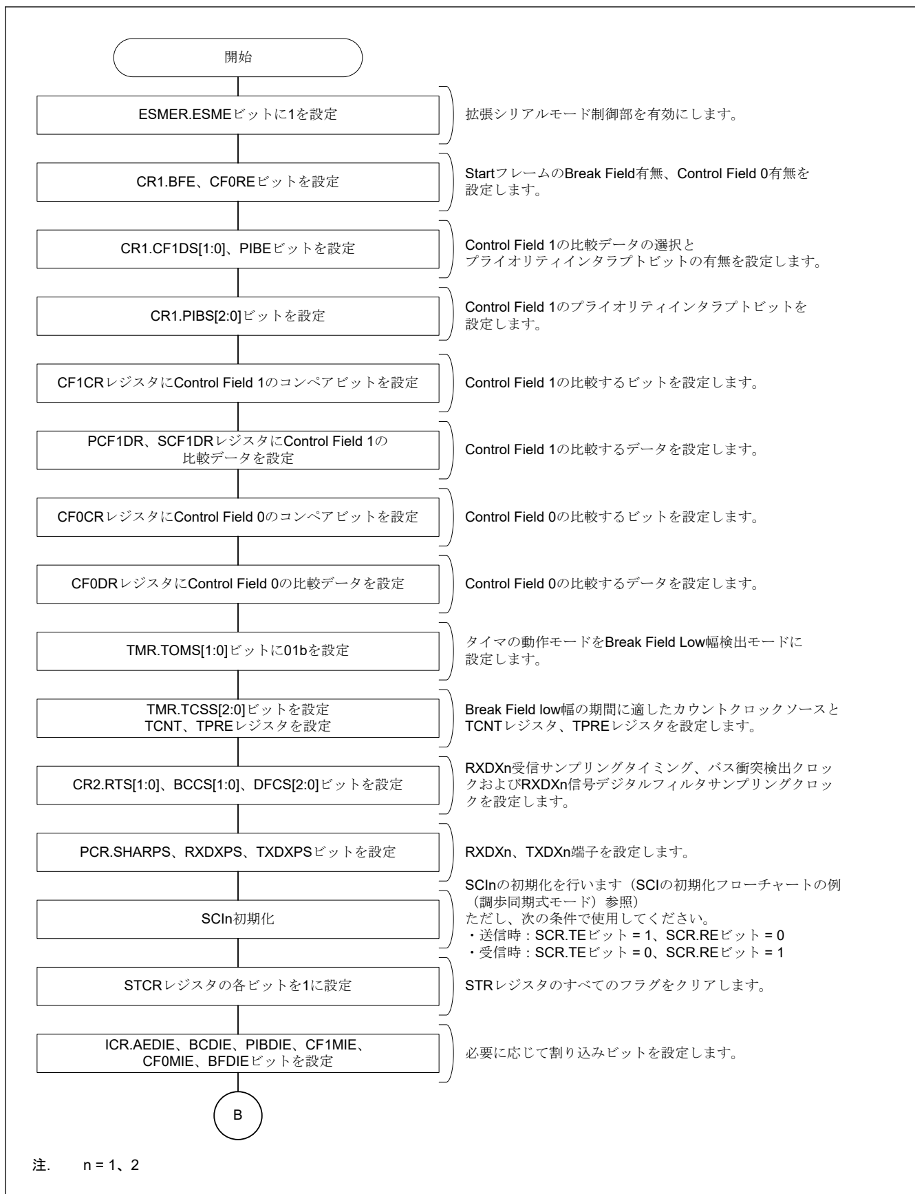
図 29.107 Start Frame 受信フローチャート例 (1)
