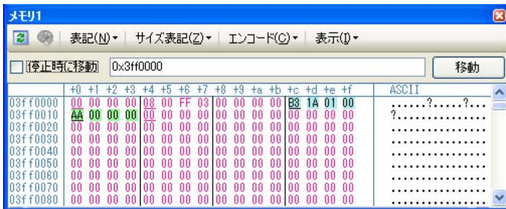
図 2—197 RRM 機能によるリアルタイム表示更新を行っているメモリ表示の例（メモリパネル）【IECUBE】
