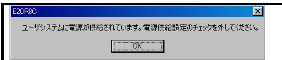
図 4.26 ユーザシステム側の電源供給確認ダイアログボックス
