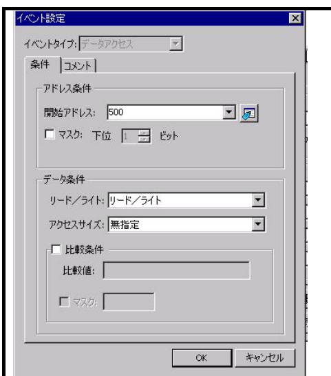
図 5.16 [イベント設定]ダイアログボックス (DAイベント) 設定例
