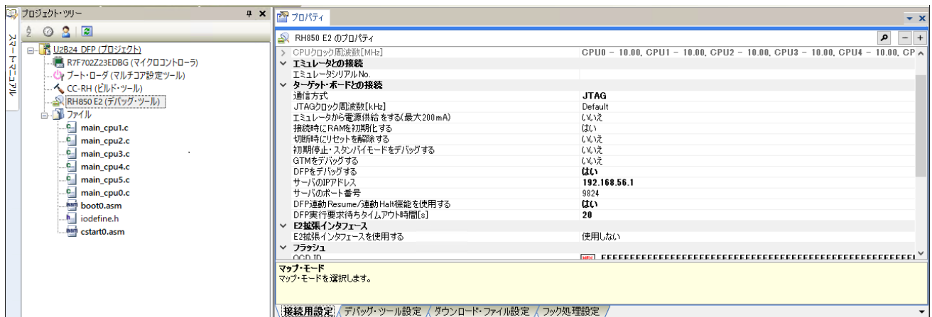
図 3-1 G4MHとDFPの連動デバッグのCS+ E2エミュレータプロパティ設定参考(接続用設定タブ)
