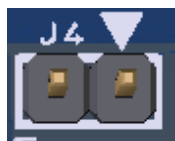
図 10 ピンヘッダジャンパ J4
