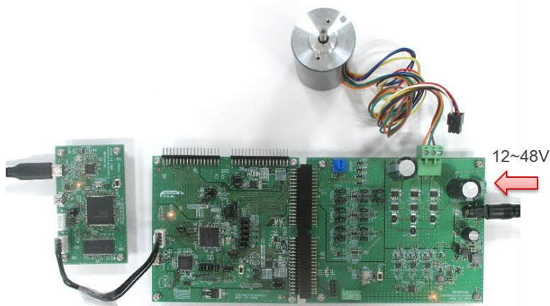
図 4-10 DC ジャックから電源供給
