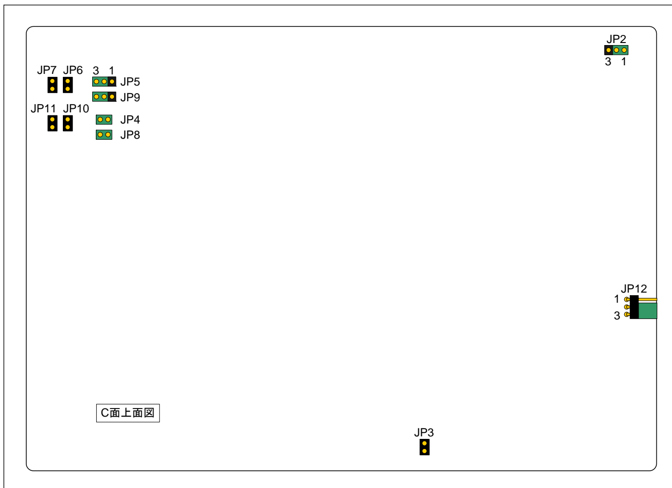
図6.2.2 M3A-HS64G01ジャンパ配置図（JP2～JP12）
