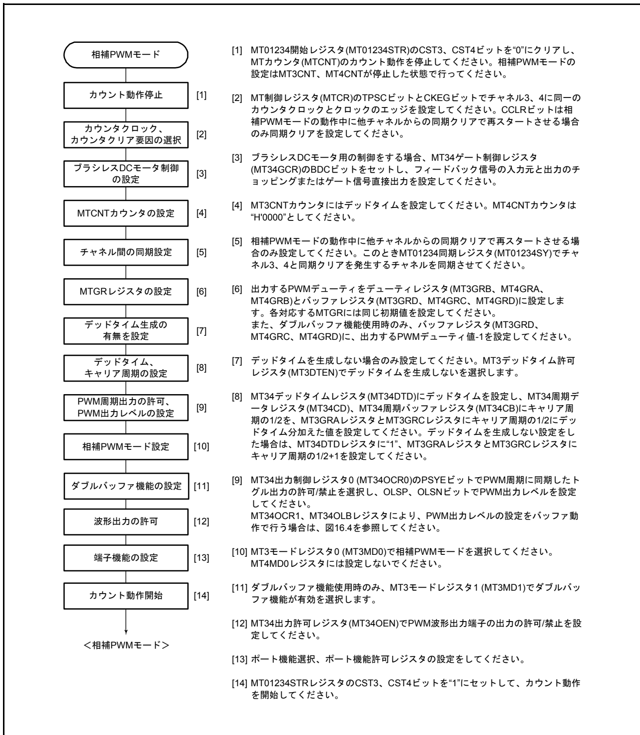
図 16.39 相補 PWM モードの設定手順例 (チャンネル 3、4)
