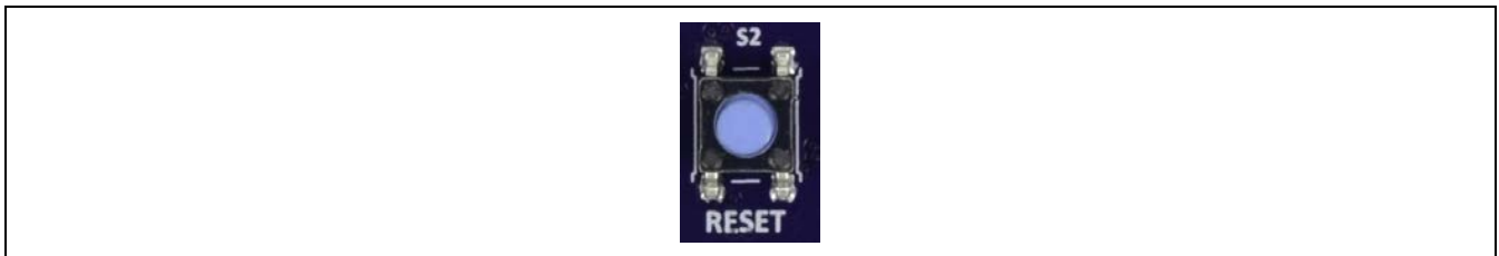
図16 ターゲットボード上のリセットスイッチ (S2)
