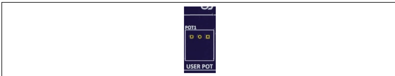
図24 ターゲットボード上のユーザポテンショメータ（上面）
