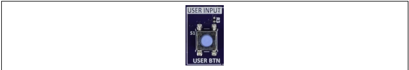
図14 ターゲットボード上のユーザスイッチ (S1)
