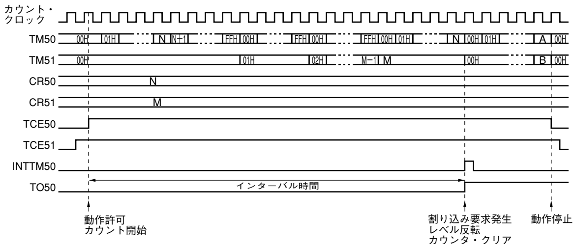
図7-13 16ビット分解能カスケード接続モード
