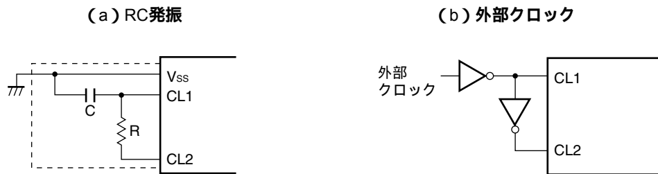
図5 - 10 外部RC発振回路の外付け回路
