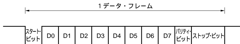
図9-7 アシンクロナス・シリアル・インタフェースの送受信データのフォーマット
