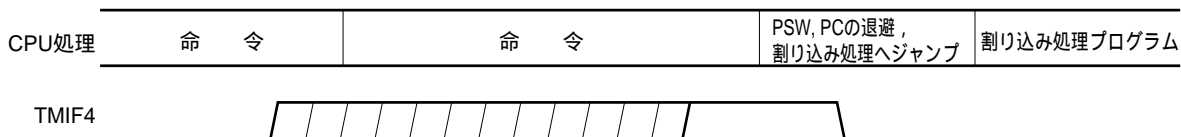
図10 - 10 ノンマスカブル割り込み要求の受け付け動作
