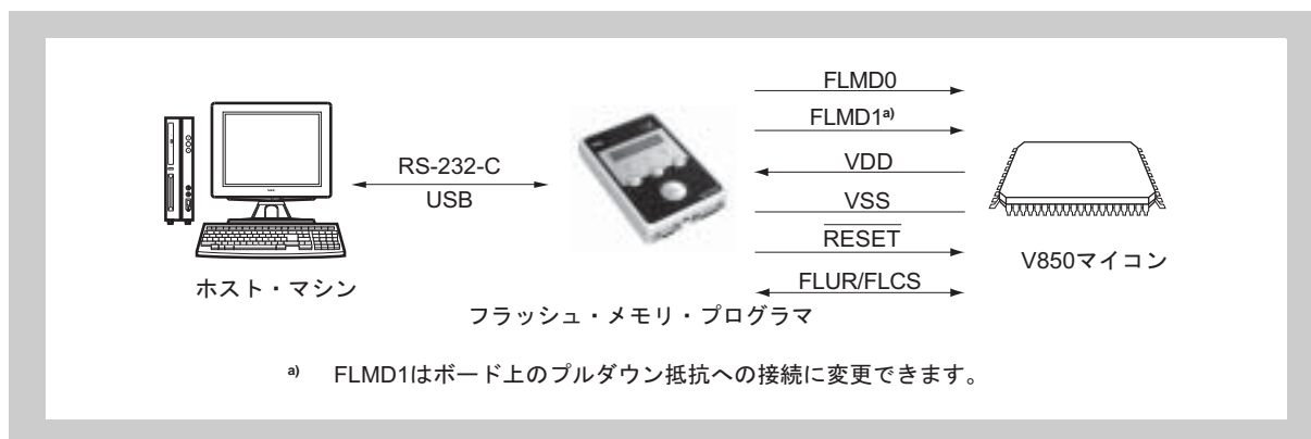
図 6-1 フラッシュ・メモリにプログラムをライトするための環境
