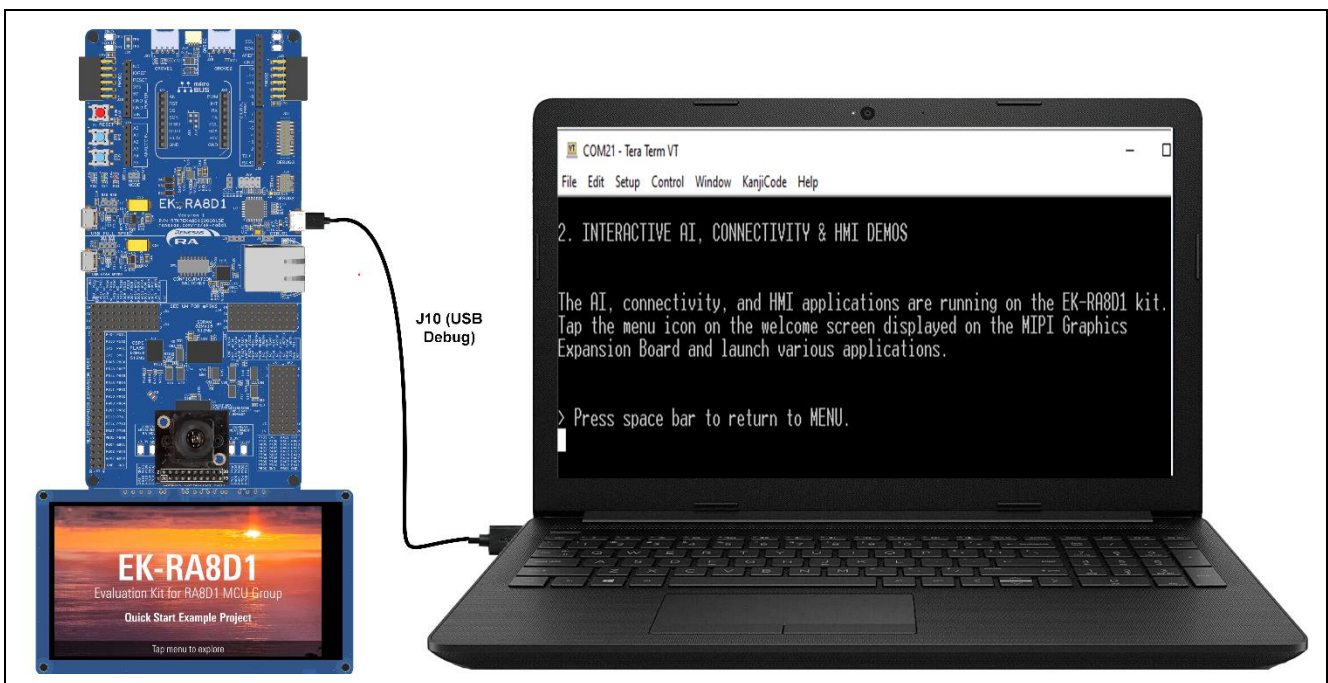
図 7. EK-RA8D1 ボードを USB フルスピードポート経由でホスト PC に接続
