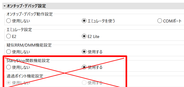
図 3-9 [システム]ページでの「Start/Stop 関数機能設定」と「通過ポイント機能設定」を削除
