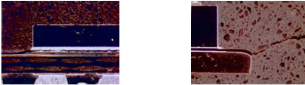
図4-12 パッケージクラック写真
